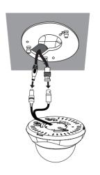
그림과 같이 11.2 순서로 카메라 마운트 브래킷에 카메라를 결합하세요. <한국어> 手順 1 と 2 の図のように、カメラと取付け金具を組 <日本語> <简体中文> 按图中步骤 1 和 2 所示装配摄像机和安装架。 如圖例步驟 1 及 2 所示,組裝攝影機與底座托架。 <繁體中文> بر طبق شکل های 1 و 2 دوربین و پایه نگه دارنده آن را به هم وصل نمایید.
